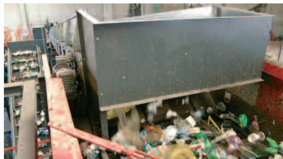
Vaglio basculante per selezione plastica.
