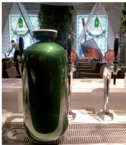
*Per la nuova tecnologia di spillatura, Carlsberg utilizza fusti in Pet totalmente riciclabili, che permettono un'innovativa spillatura senza CO<sub>2</sub>.*
